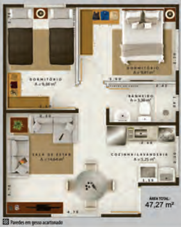
☑ Paredes em gesso acartonado
